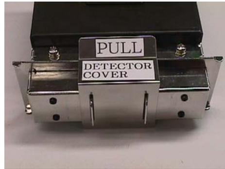
カバー装着後の検知器先端部
